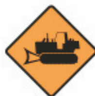
T. 7 EQUIPO PESADO EN LA VÍA
