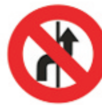
R. 10 PROHIBIDO CAMBIAR DE CARRIL
