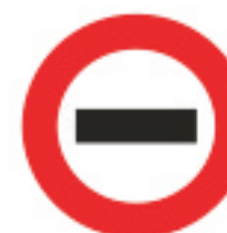
R. 25 PUESTO DE CONTROL
