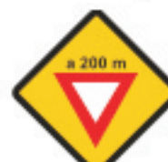
P. 33 (b) PROXIMIDAD DE SEÑAL RESTRICTIVA
