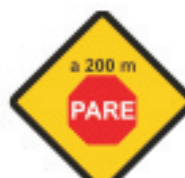
P. 33 (a) PROXIMIDAD DE SEÑAL RESTRICTIVA
